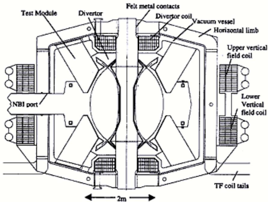
Figure 28. The MAST Tokamak.
